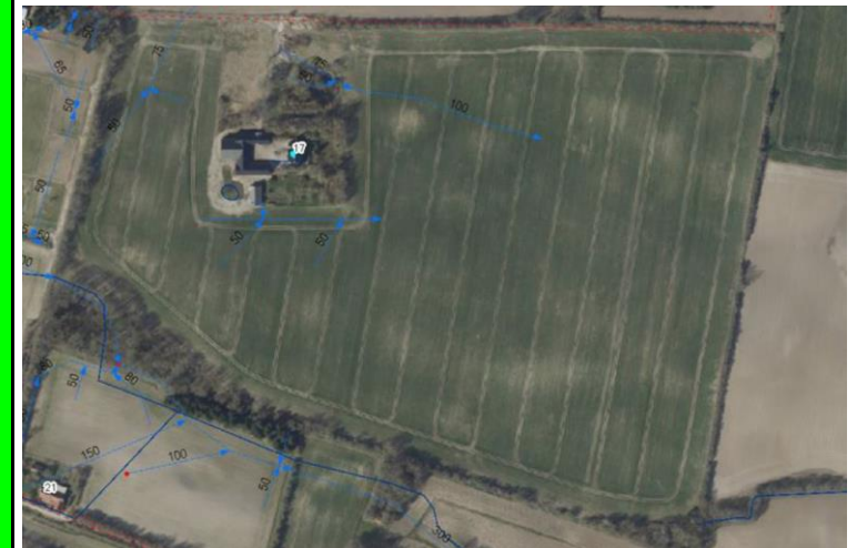
Kort 2: Illustration af eksisterende dræn på ejendommen. Linjerne illustrerer drænstrækningen, mens pilene illustrerer retningen for vandets forløb.
