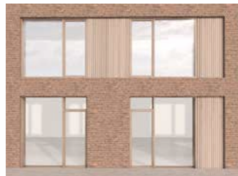
HOTEL FACADE MED MURVÆRK OG TRÆBEKLÆDNING
