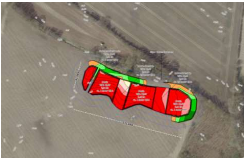
Figur 1. Minivådområdet opbygning og placering af overskudsjord.
