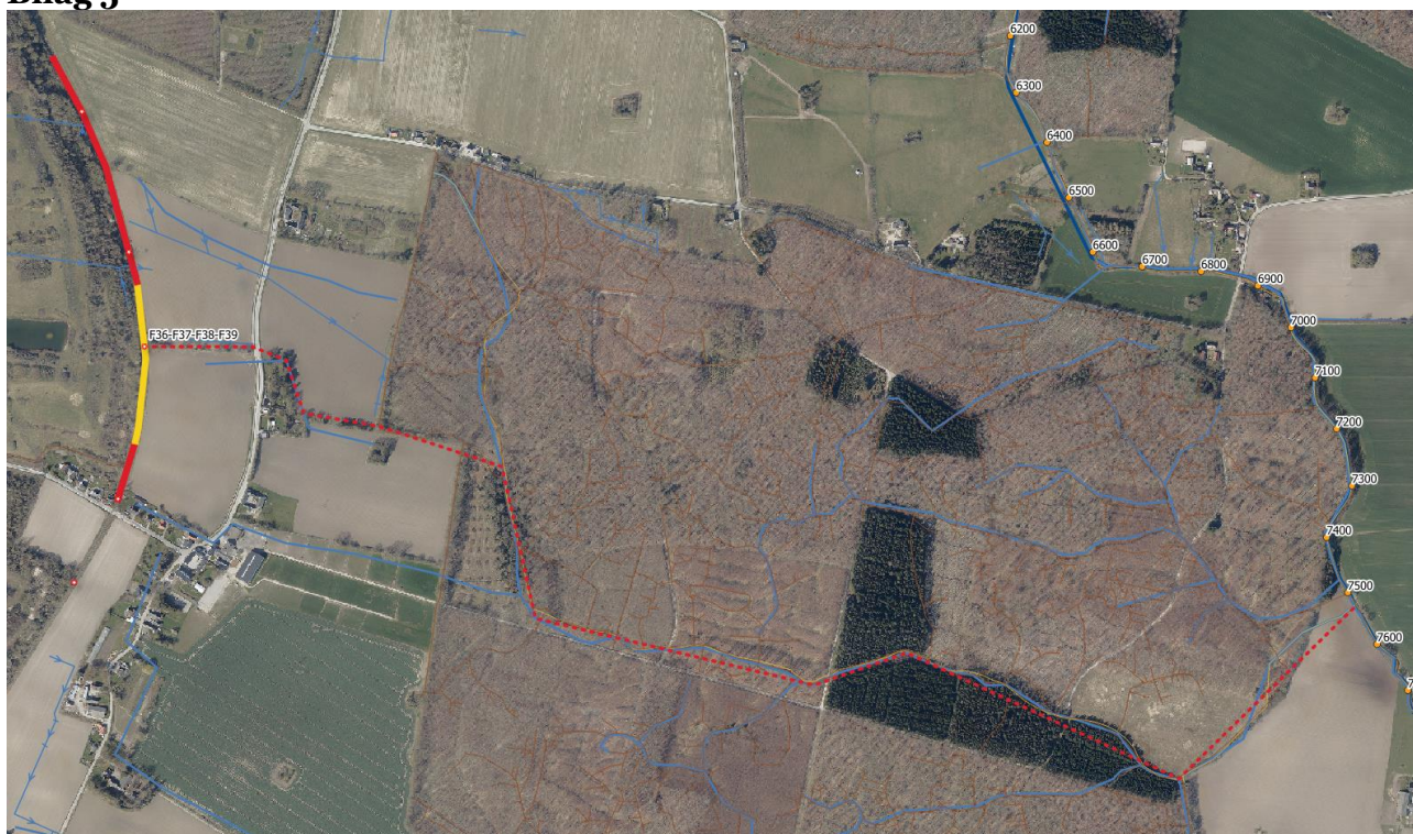
Figur 10 Udledningspunkt F38 (f36-F39). Rød stiptet er vandets vej til recipient. Blå er Vivede Mølleå
