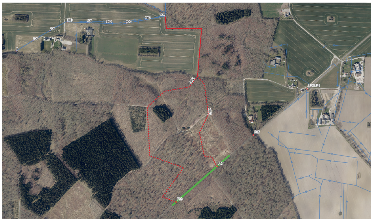
Figur 9 Udledningspunkt F17 og F18 og vandets vej til recipient (rød stiptet). Blå er Pebringe Bæk
