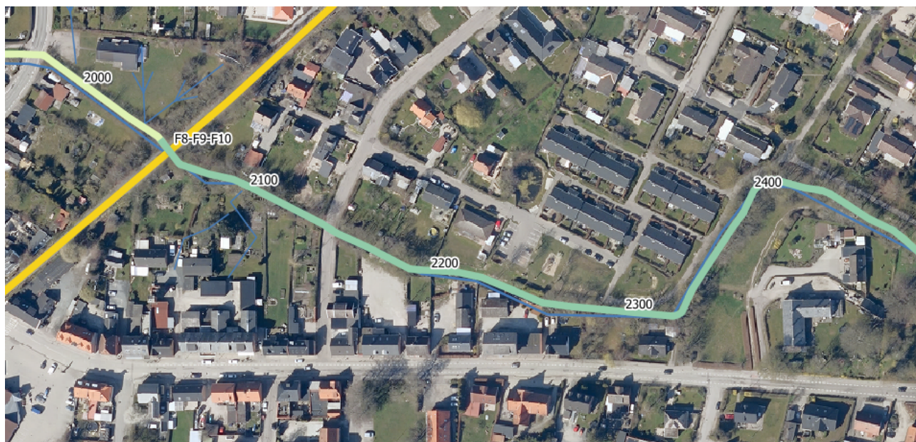
Figur 12 Strækning, hvor der jævnfør vilkår skal udlægges sten i vandløbet. Fra udledningspunktet F8-F9-F10, hvor jernbanen krydser vandløbet til svinget ved vandløbets st. 2.400.
