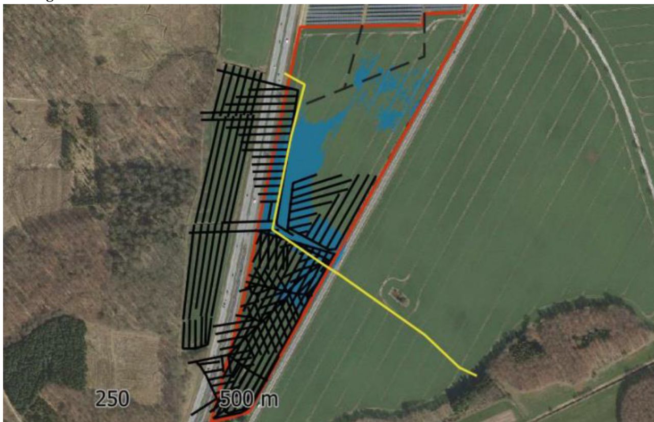
Turebylille site. De sorte streger viser det ødelagte drænsystem, mens den gule linje er et større rørlagt vandløb, som er intakt.
