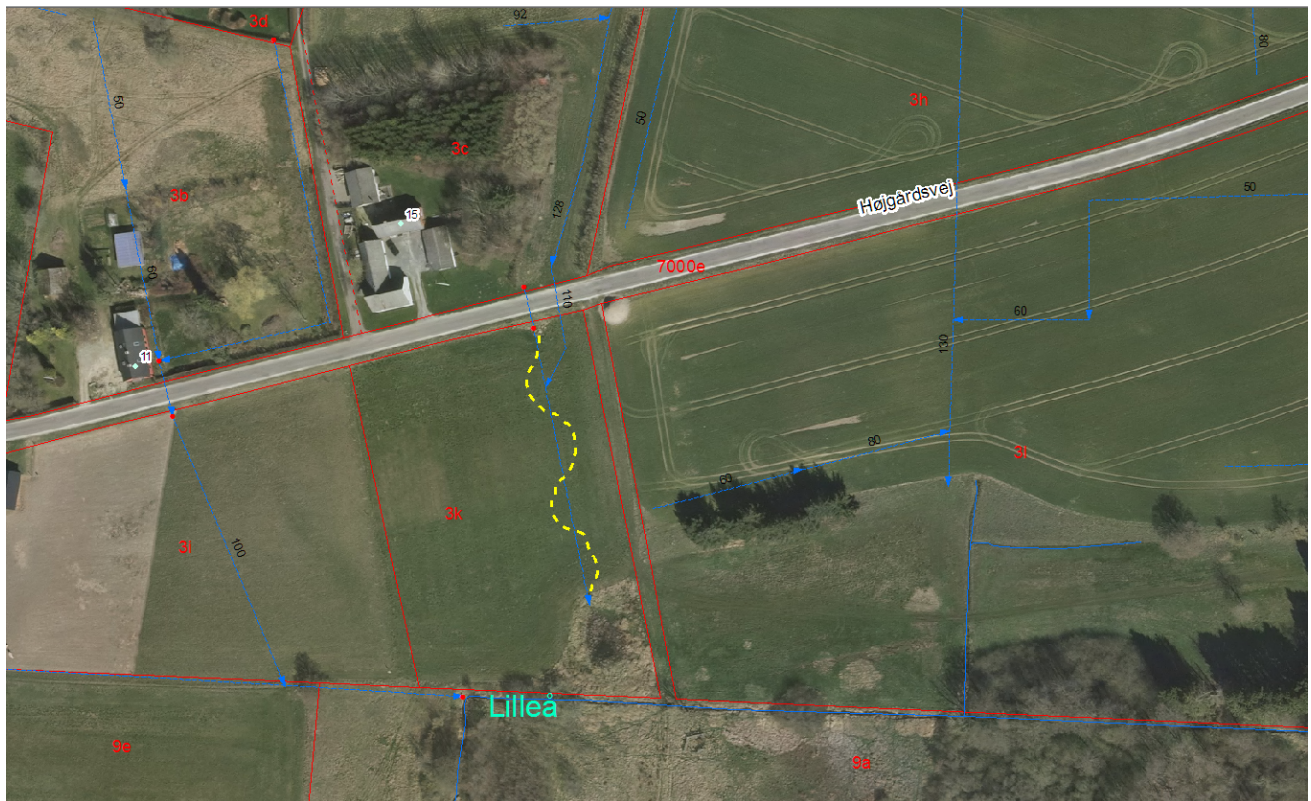
Detailkort. Gul stiplede linje viser nyt vandløb. Kendte dræn vises med blå, matrikelskel vises med rød.
