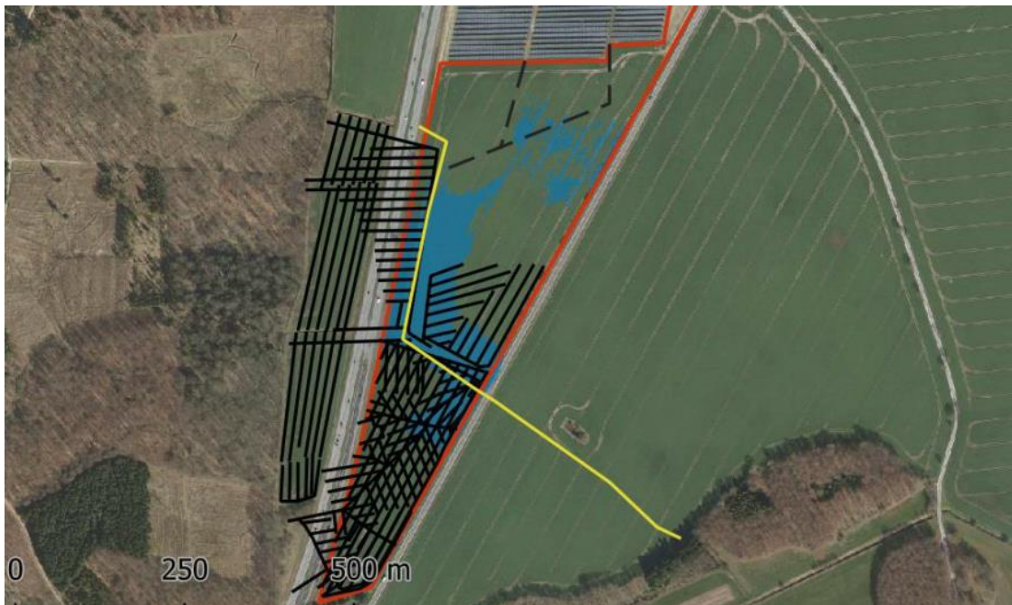
Oversigtskort 2. Placeringen af det eksisterende drænsystem der er beskadiget ved etablering af solpanelerne fundament i området.
