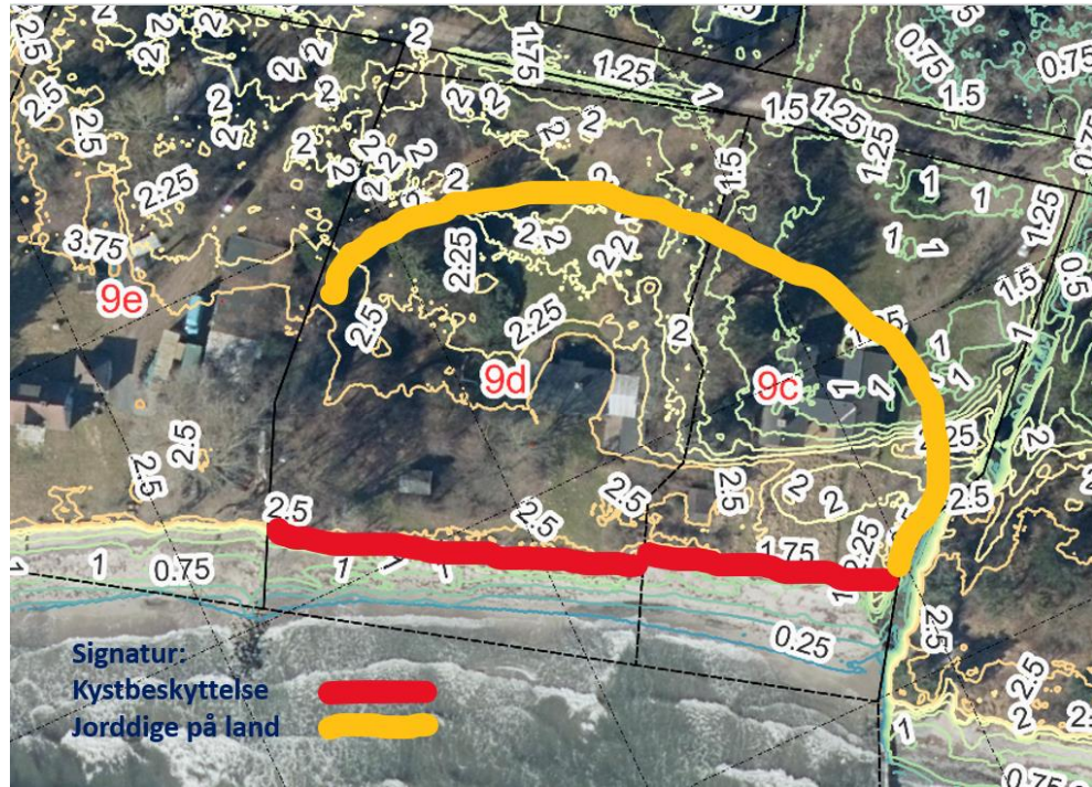
Figur 5-4 Matrikel 9c og 9d, nr. 1 og 3 med kystbeskyttelse mod havet og oversvømmelses-dige på land (forslag)
