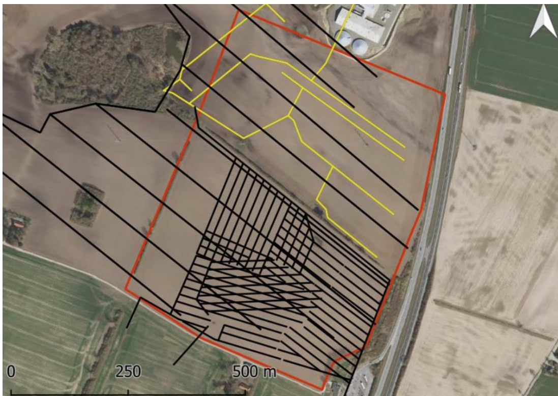
Oversigtskort 2. Placeringen af det eksisterende drænsystem der er beskadiget ved etablering af solpanelerne fundament i området.
