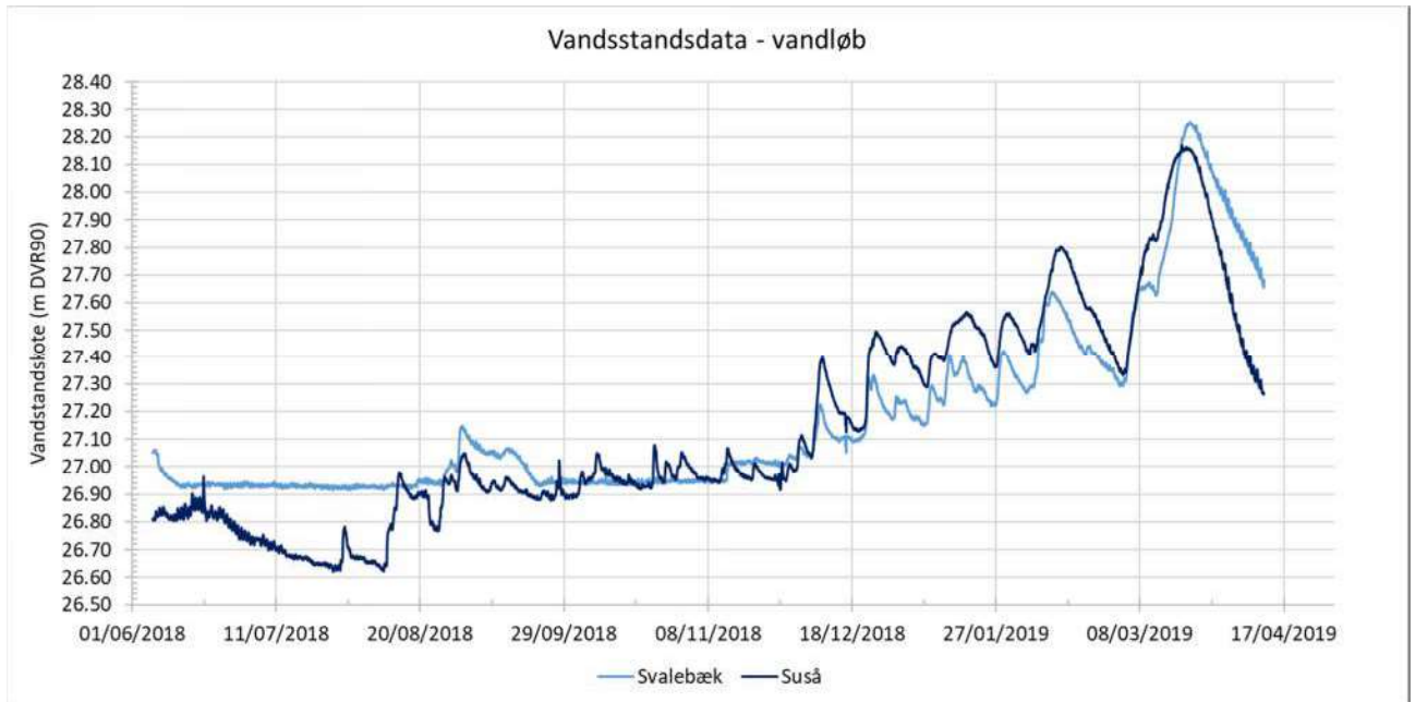
Figur 4-15 Vandstand målt i vandløbene
