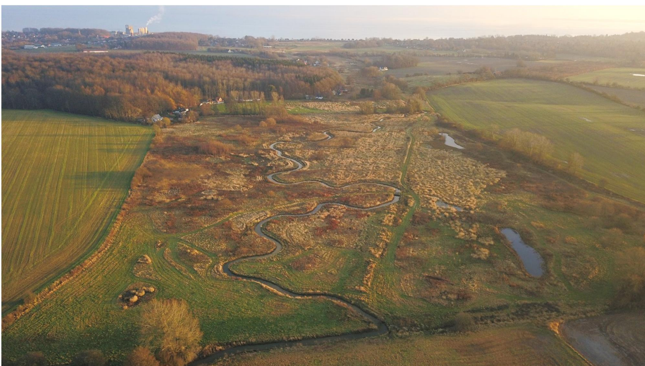
Foto 8. Genslynget del af vandløbet fra st. 6300 til ca. st. 6700. Her er vandløbet med relativt lavt fald og med stor vanddybde, samt mudret bund. Der er dog stryg ind imellem.
