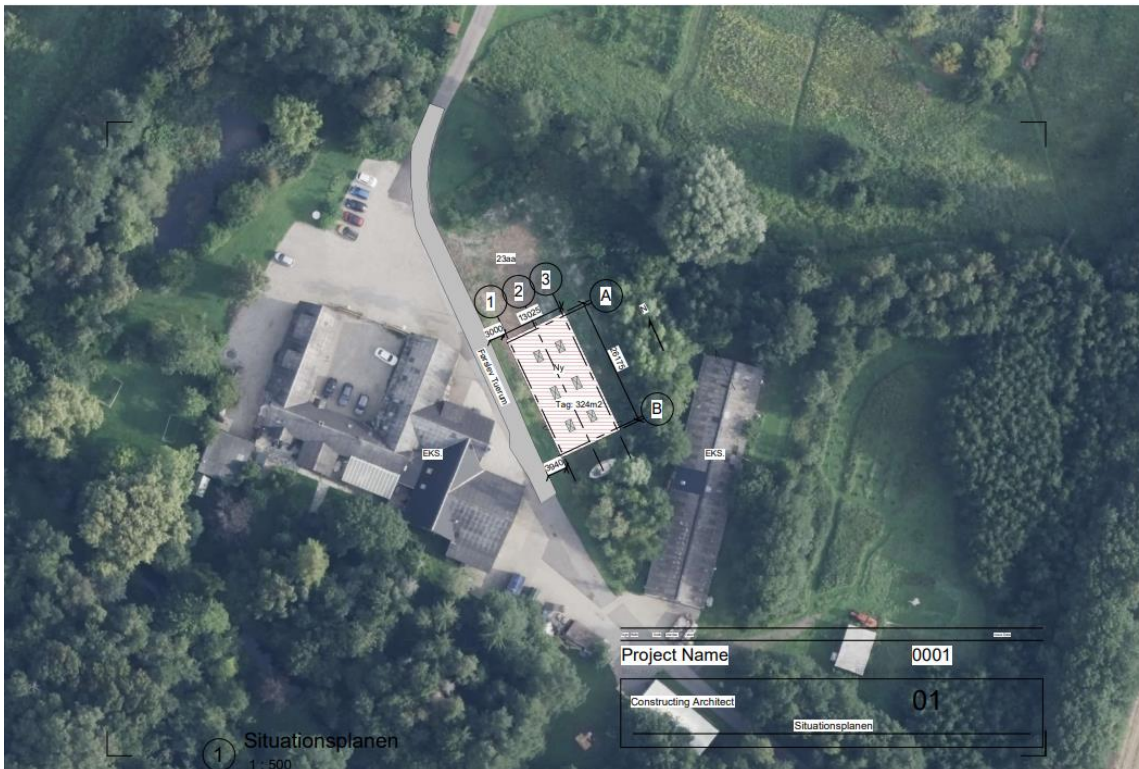
Figur 2 - Ny placering af erhvervshal markeret med hvid tegning. Der er på situationsplanen ikke indregnet halvtag på bygningen. Halvtaget fremgår af opstalt.
