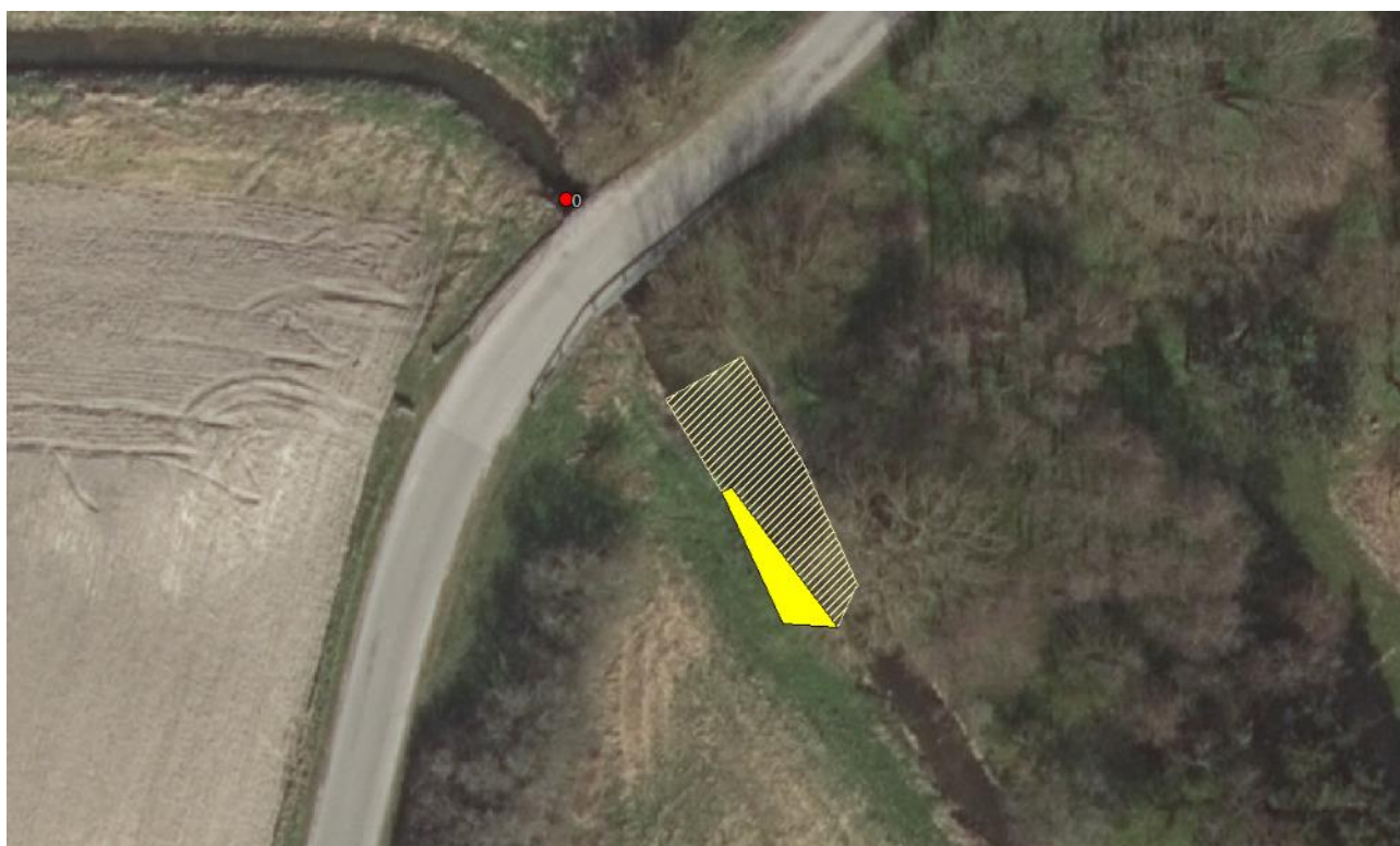
Figur 9. Sandfang st. 15-35. Gul flade viser brink, der skal afgraves. Skraveret viser resten af sandfangets udbredelse.
