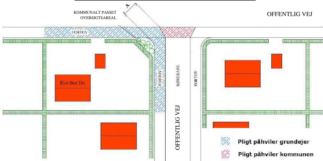
Figur 6, Pligten for ejere af en hjørnegrund der grænser til 2 offentlige veje, hvor vejtilslutningen er udført med afvigende belægning i forlængelse af den ene vejs fortov – eller som gennemgående fortov langs denne. Pligten for selve vejtilslutningen påhviler kommunen.
