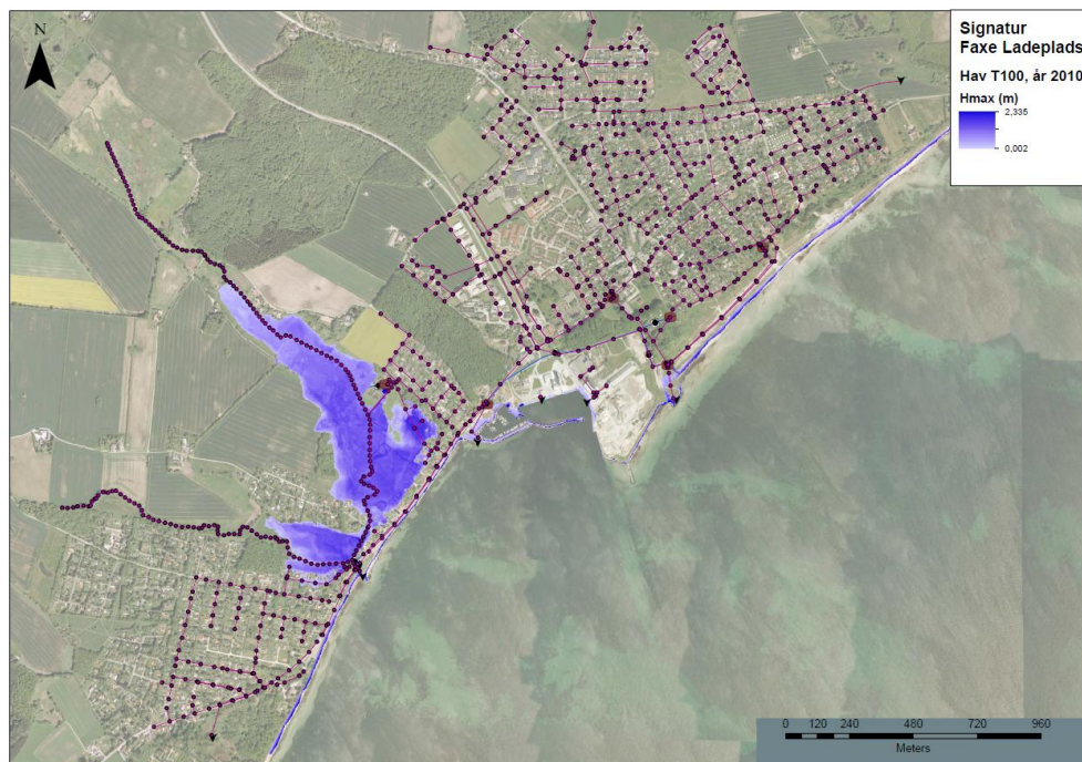
Figur 6-8 Faxø Ladeplads med modelleret oversvømmelse fra Stormflod ved en 100 års hændelse i 2010.
