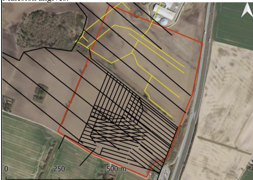
Oversigtskort 2. Placeringen af det eksisterende drænsystem der er beskadiget ved etablering af solpanelerne fundamentet i området.
