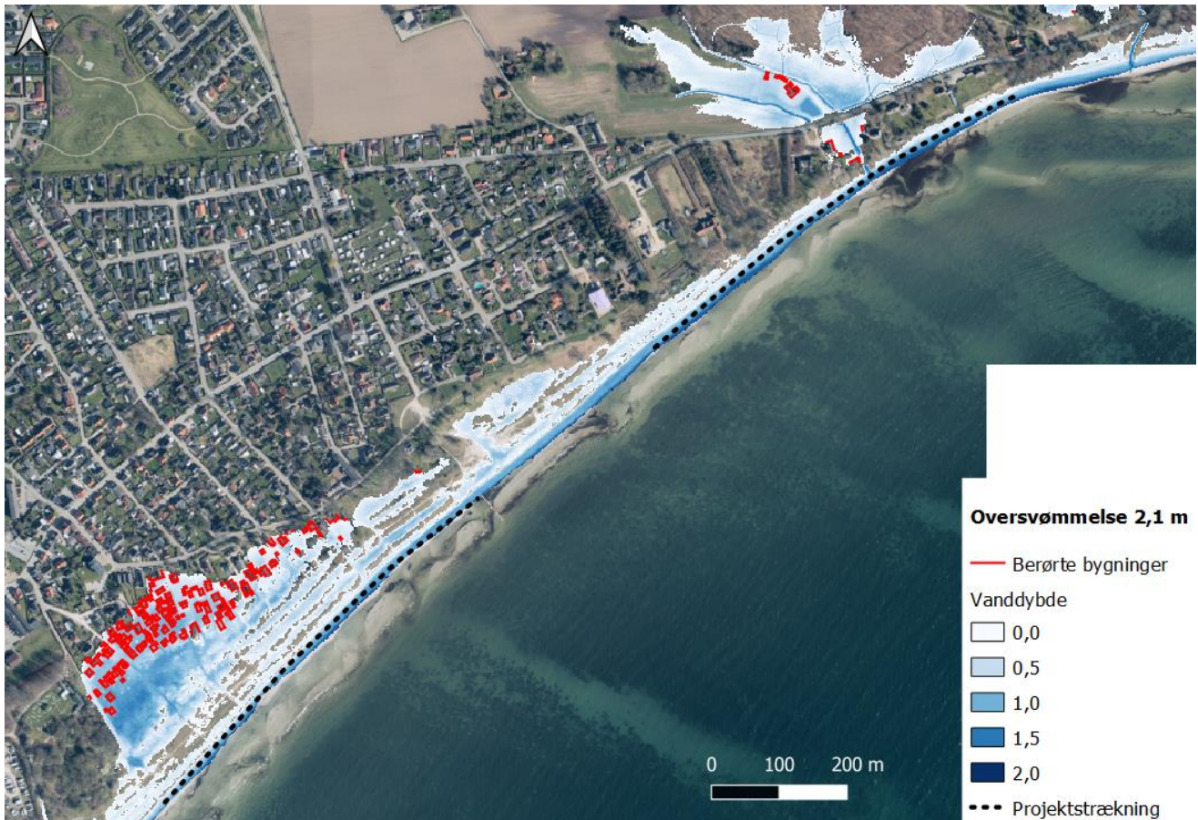
Figur 5.1: Oversvømmelse i projektområdet ved en forventet ekstremvandstand i år 2075 på 2,1 m. Baggrund: Ortofoto 2023.
