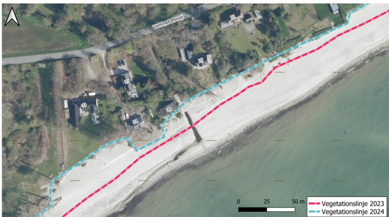
Figur 4.3: Tilbagerykning af vegetationslinjen fra 2023 til 2024 ved særligt erosionstruet område langs den nordlige strækning. Baggrund: Ortofoto 2024.
