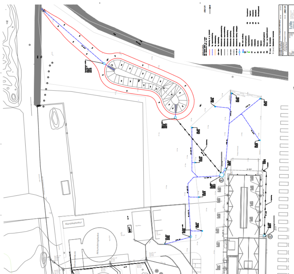
Figur 1 - Med rød ses placering og udformning af regnvandsbassinet
