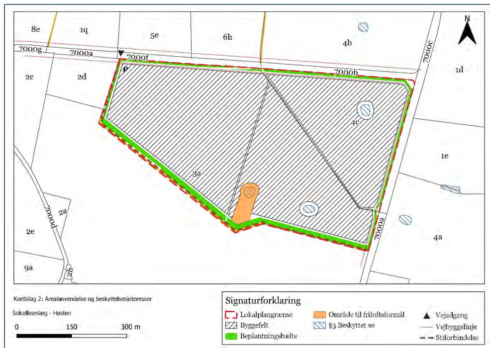
Figur 1-3 Lokalplankort, som viser områdets disponering med byggefelt til solcelleanlæg, beplantningsbælter, vejadgange mv.
