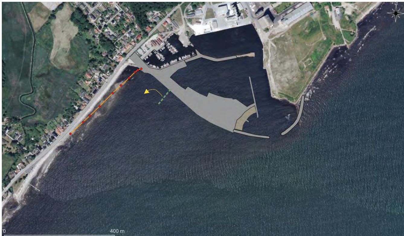
Figur 8.2 Estimeret kystlinje svarende til en netto-transport på ca. 20.000 m 3 /år. Den stiplede grønne linje angiver en mulig position for en dykket struktur/et kunstigt rev. Den prikkede gule pil antyder konceptuelt returstrømmen fra brydende bølger hen over strukturen/revet.
