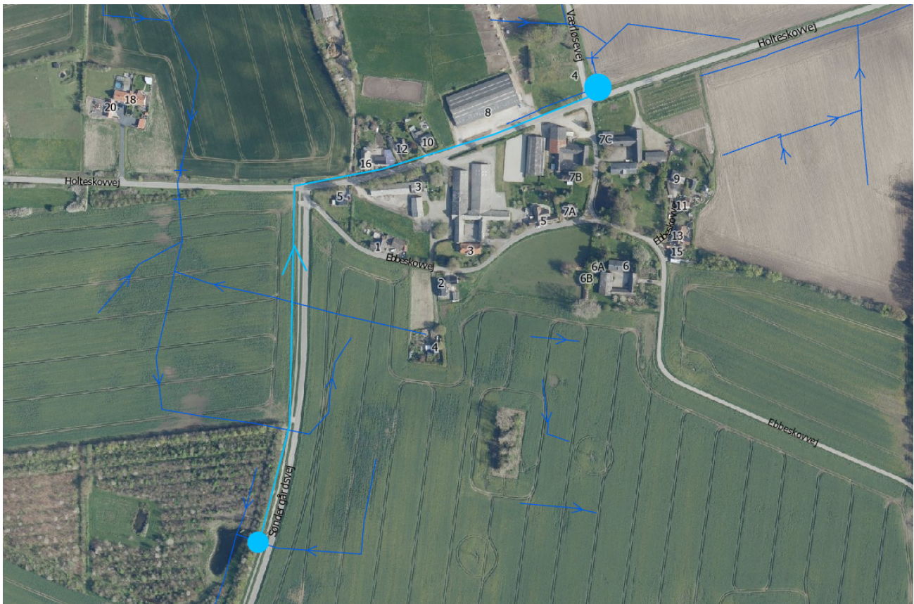
Figur 1. Vandet pumpes fra blå cirkel ved skoven via den lyseblå ledning til hovedledning ved blå cirkel øverst.
