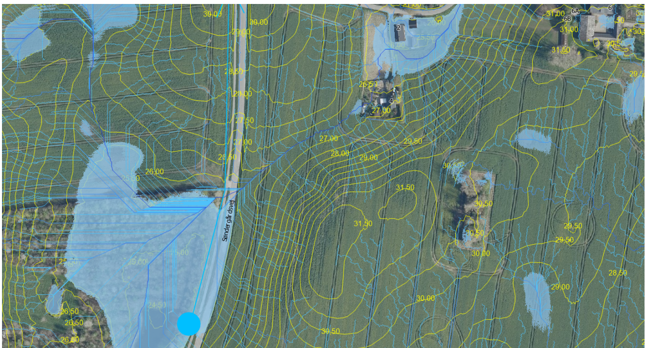
Figur 2 viser terrænkurver (gul) og strømningsveje (blå striber). De blå områder er hvor vandet vil samle sig ved en situation med ekstremregn. Pumpebrønden vises med lys blå cirkel nederst.
