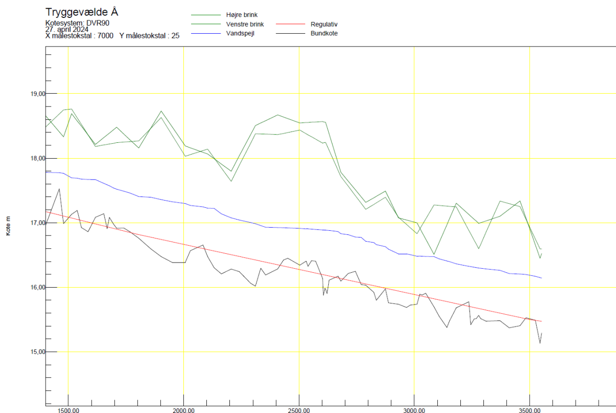
figur 4 viser opmåling af Tryggevælde Å mellem station 1400-3352, nuværende bundkote er sort streg, der flere steder er over bundkoten beskrevet i regulativet (rød streg)
