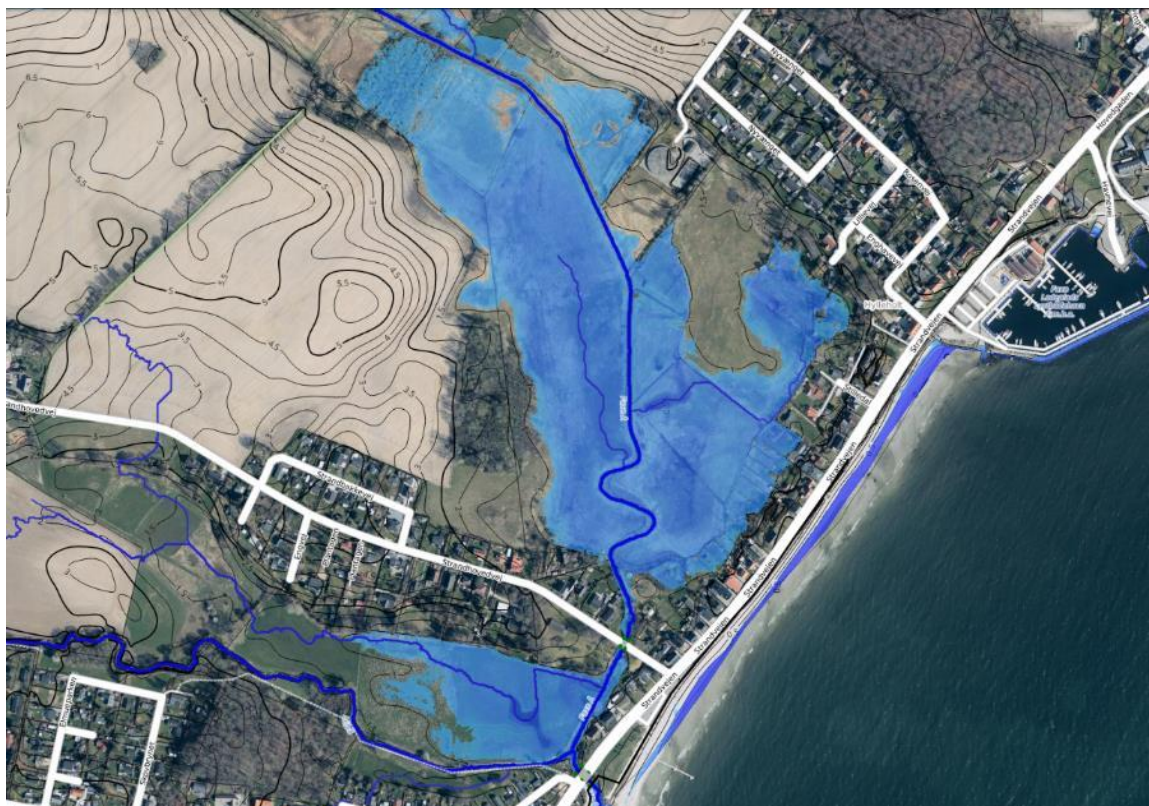
Figur 4-15 Opstuvning langs Faxe Å og Lilleå ved en havvandstand i kote 0,9. Højere vandstand vil medføre bygningsoversvømmelse startende på strækningen mellem Strandvejen 28 og 42. Engarealet, hvorpå der vil kunne opstaves vand ses tydeligt langs Faxe Å.
