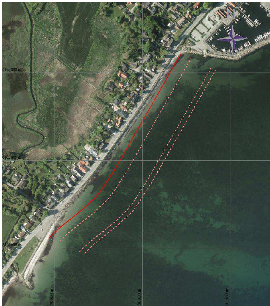
Figur 6.4 Skitse plan layout af strand. De stiplede linjer er -1, -2 og -2.25 m kurverne.
