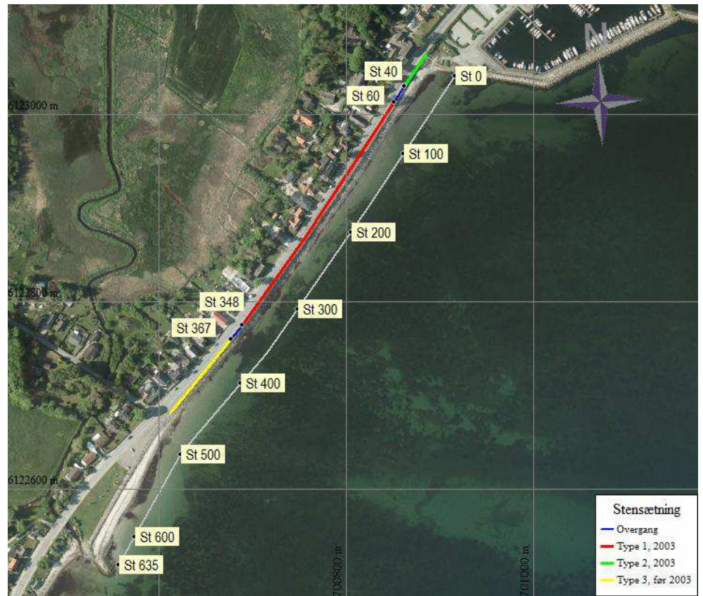
Figur 5.1 Skitse af de forskellige stenkastningstyper.
