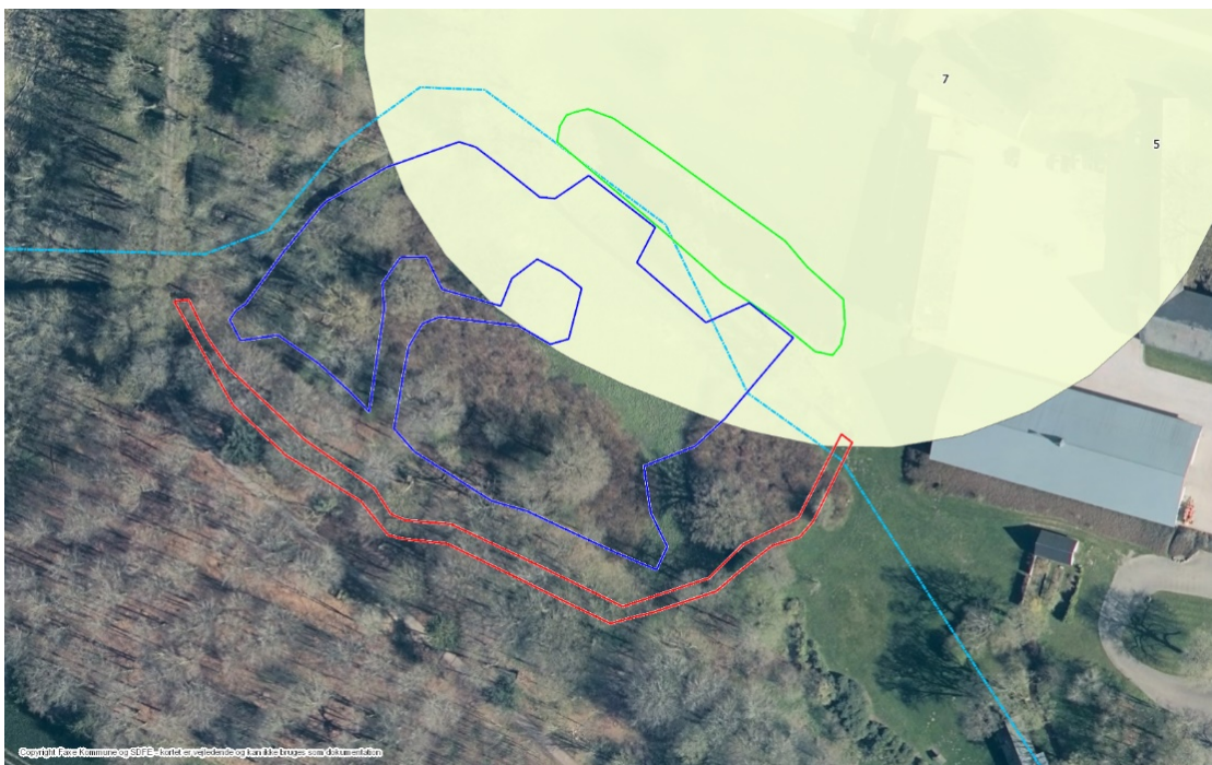
Fig 2. Den § 3 beskyttede sø er markeret med grøn omkreds , fortidsmindebeskyttelseslinjen er markeret med gult, ca. projektområde er markeret med mørk blå skravering, lyseblå streg er vandløbets nuværende forløb, nyt forløb for vandløb er markeret med rødt.
