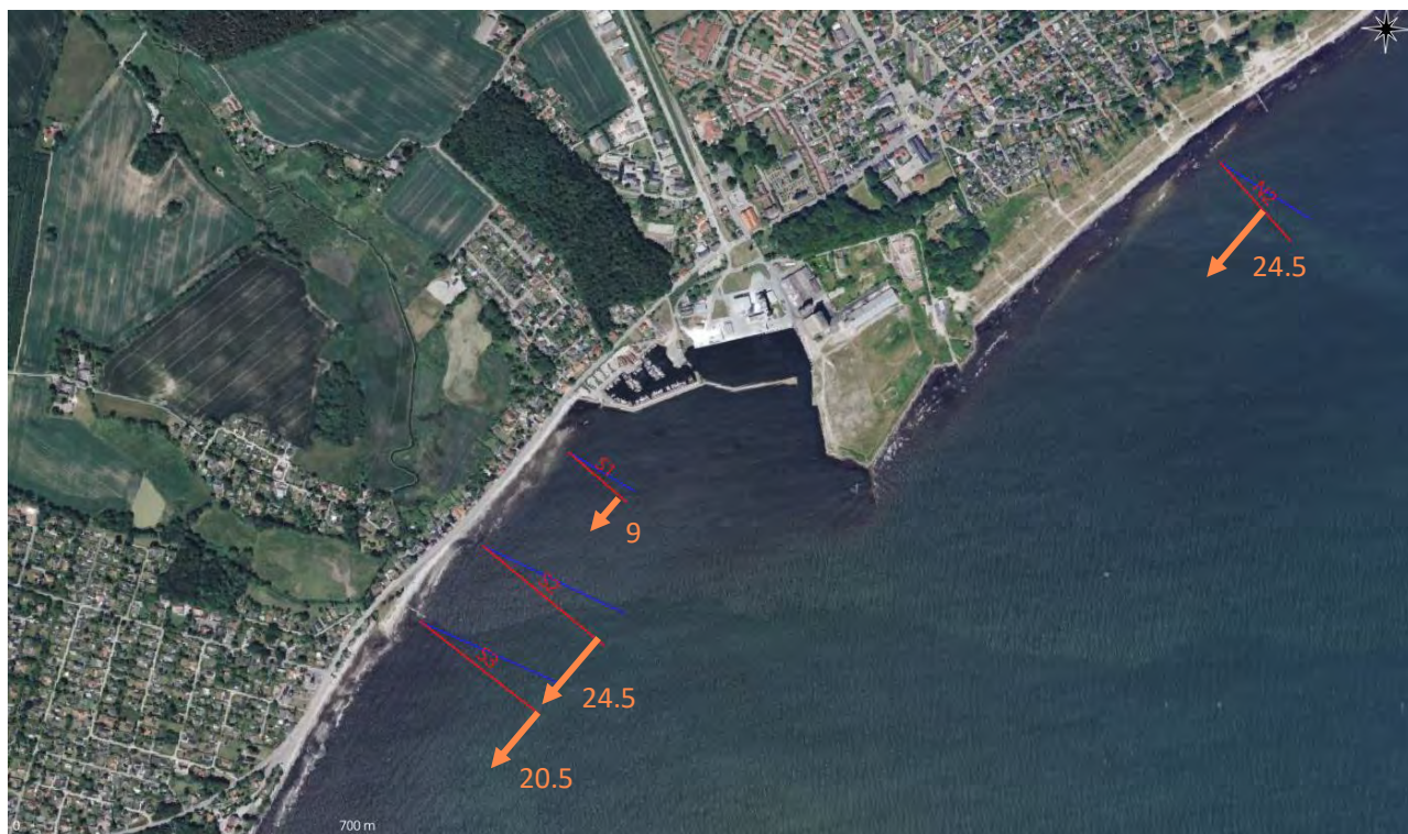
Figur 5.4 Oversigtskort for modelleret kysttransport under eksisterende forhold.
