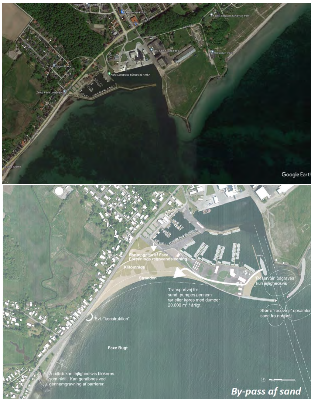
Figur 2.1 Oversigtskort over Faxe Ladeplads Havn. (Top) Eksisterende havn baseret på et satellitbillede fra Google Earth. (Bund) Planlagt udvidelse inklusive foreslået sand by-pass-system.
