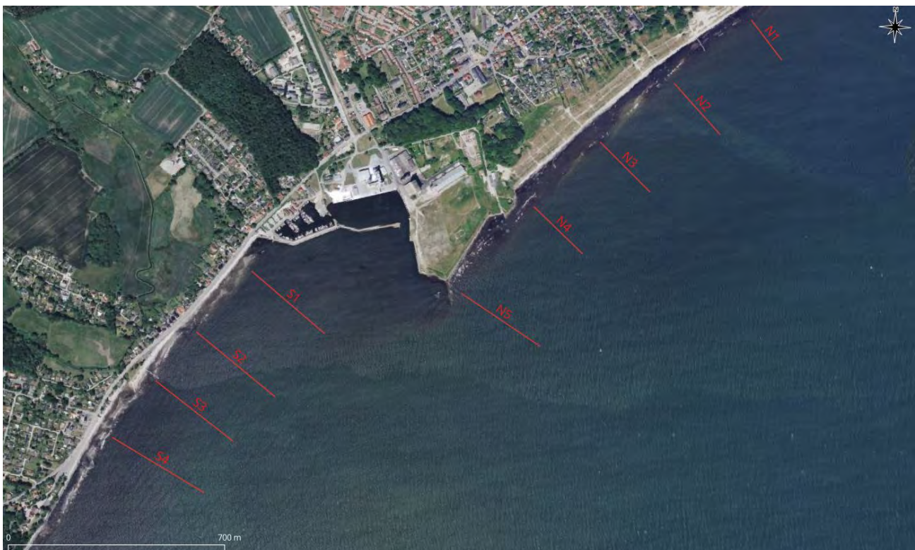
Figur 3.2 Kort over beliggenhed af batymetri-profiler.
